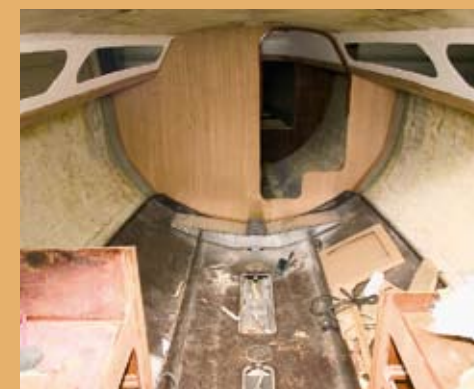
Der blev gået grundigt til værks - båden fik blandt andet nyt hovedskot.
